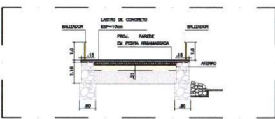
06.03 CORTE CC - PASSAGEM MOLHADA ESCALA 1:100
