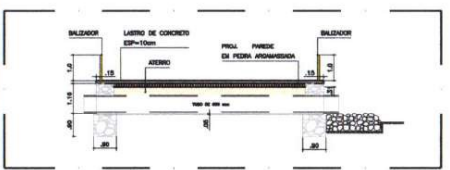
06.02 CORTE BB - PASSAGEM MOLHADA ESCALA 1:100
